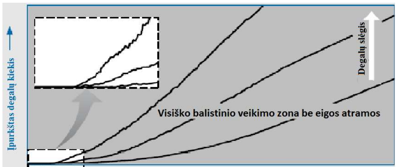
2.2.4 pav. Purkštuvu be eigos atramos įpurškiamų degalų kiekio charakteristikos[5]
