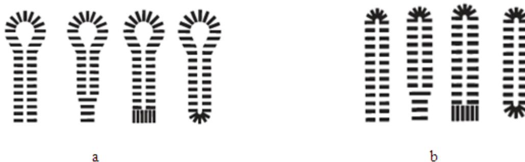
1.20.pav. „Juki“ kilpinių mašinių kilpų pavyzdžiai ir jų galų užtūrinimo būdai: a – figūrinės su apvalia galvute, b – stačiakampio formos (baltininės).
