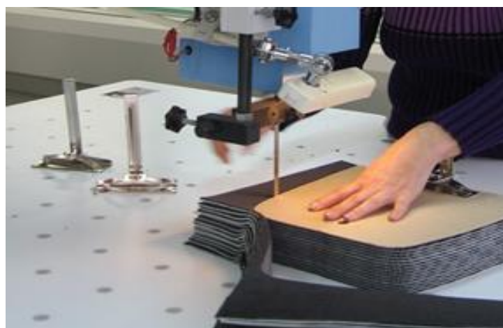
2.5.3.4 pav. Detalių iškirpimas automatizuotu būdu
