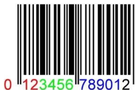
3.3.2.2 pav. Brūkšninio kodo pavyzdys: trys pirmi raudoni skaičiai (012) šalies kodas; žaliai pažymėti (3456) – gamintojo kodas; mėlyni (78901) – prekės indentifikavimo numeris; Juodas (2) – kontrolinis skaičius
