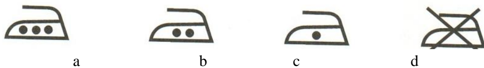
3.3.1.4 pav. Lyginimo simboliai nurodo leistiną lygintuvo įkaitimo temperatūrą, žymimą skaičiais arba taškais: a – aukščiausia temperatūra – 200°C; b – aukščiausia temperatūra – 150°C; c – aukščiausia temperatūra – 100°C; d – lyginti negalima
